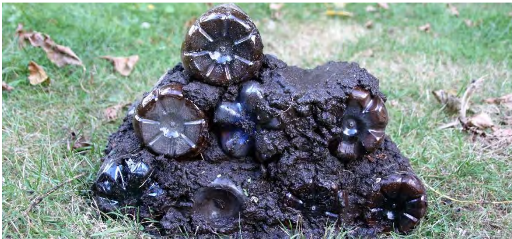
Hausbau mit Kunststoffflaschen
