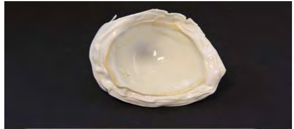
Deckel von Einwegbechern nach dem Thermoformen
