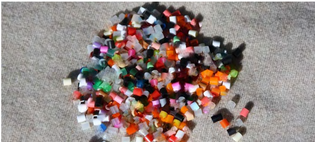
Kunststoffgranulat, welches von kunststoffproduzierenden Unternehmen hergestellt wurde
